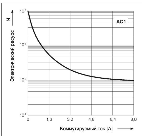
Электрический ресурс по функции тока нагрузки. Диаг. 2 Частота коммутации: 600 циклов/час - TR4N 2 CO
